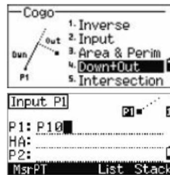
輸入沿基準線的水平距離(Dwn)，及與基準線成垂直的水平偏心值 o/s 和高差 dVD
