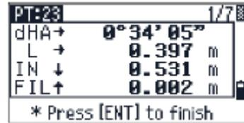
一旦測量完成，挖/填值和 Z 座標都將由於 VA 角的變化而得到更新。
